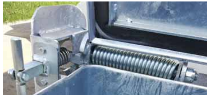
Deckelarretierungs- und Deckelanhebungsfedern
