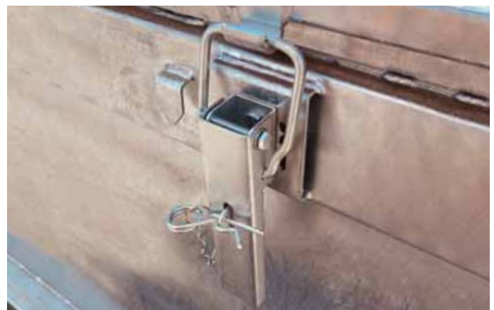
Deckelverschluss - verschlossen und gesichert
